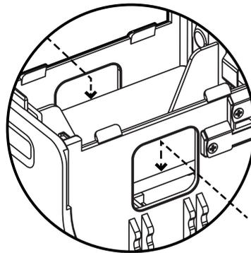
Les trous sur le côté sont conçus pour retirer facilement les piles.
