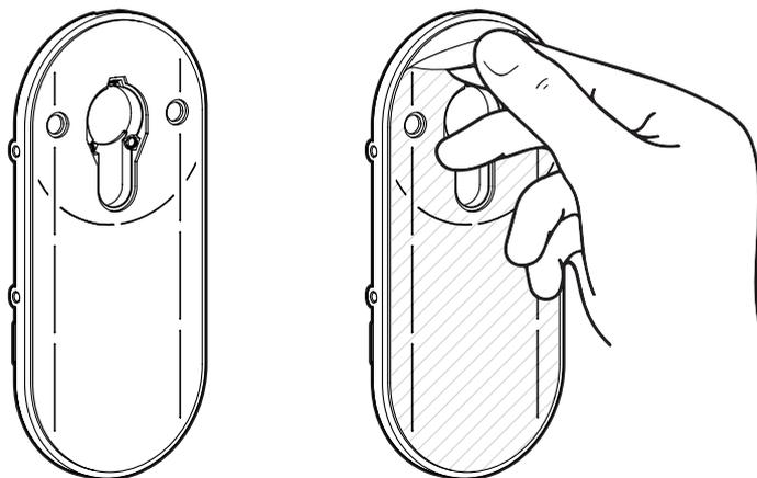
Placez la plaque de montage sur le cylindre de serrure et fixez-la avec la clé Allen fournie.
